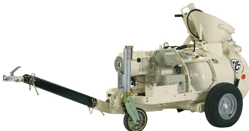
Estrich Boy 20<sup>E</sup> маленький пневмонагнетатель, особенно пригодный, для проведения небольших работ по укладке стяжек. При помощи автономного компрессора, возможна обработка материала на цементной-, кальковой основе, а также лёгкого бетона с фракцией до 16 мм. С электрическим мотором, мощностью 7,5 kW Estrich Boy достигает производительности 2,5 м<sup>3</sup>/час.
