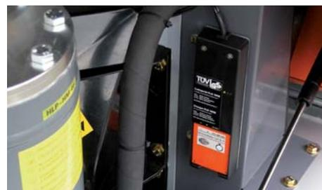
Зарядное устройство для аккумулятора радиоуправления
