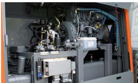
Power-пакет с 4-х цилиндровым дизельным двигателем
