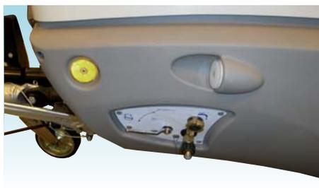
Подключение для очистителя высокого давления и очистителя смесителя.
