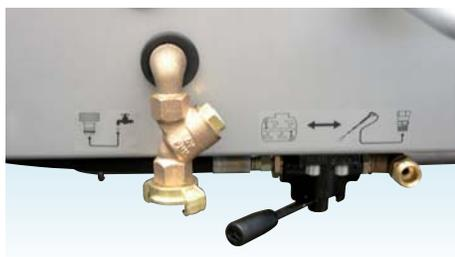
Подключеие очистителя смесителя / очистителя высокого давления
