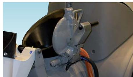
Крышка смесителя с автоматическим рычагом смесителя.
