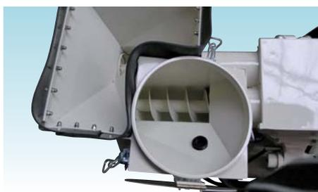
Шнековая подача материала двухкамерного бункера
