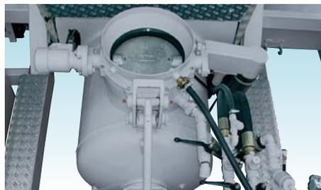
Смесительный бак с гидравлическим поворотным фланцем
