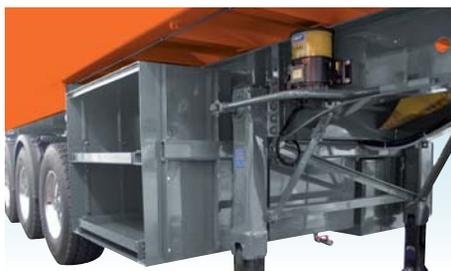
Центральной системой смазки
