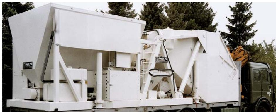
Специально для нашего швейцарского клиента, мы разработали установку для смешивания и подачи растворов для «жидких стяжек полов», которая загружается наполнителем и связующим непосредственно на строительной площадке. Причиной тому служит, недопускание к транспортировке по дорогам, тяжёлых, строительных машин.
