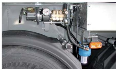
Очиститель высокого давления с подключением воды
