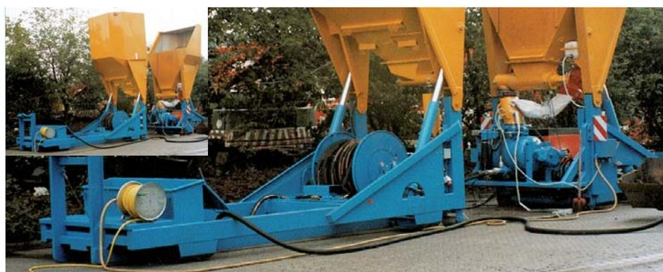
На большой строительной площадке, устанавливаются 2 скипа (1-х для связующего; 1-х наполнителя), занимающие в рабочем состоянии поднятое положение. После опустошения, скипы опускаются и вновь заполняются материалом (напр. при помощи погрузчика)
