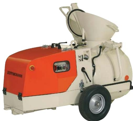
Estrich Boy 10<sup>E</sup> с мощностью двигателя 2,5 kW, самый маленький пневмонагнетатель из модельного ряда Estrich Boy. Оборудованием подключением 230 V, при помощи автономного компрессора, работает быстро и надёжно. Легко справляется с перемешиванием и подачей смесей, для стяжек полов на песчаной или известковой кальковой основе, а также, легкого бетона, с фракцией до 16 мм.
