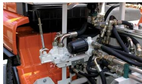
Рычаг управления гидравлическим цилиндром
