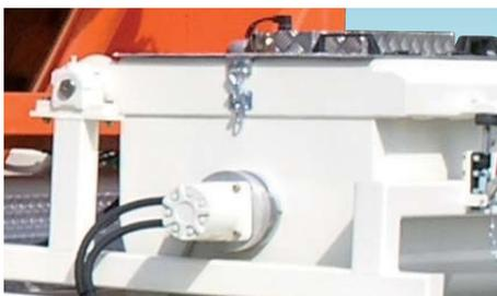
Гидравлический привод, смесительный механизм и лента подачи наполнителя.
