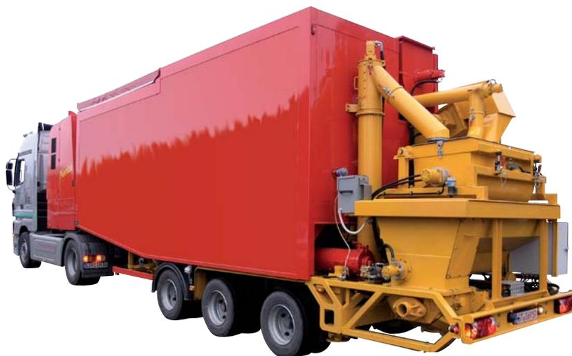
TransMix 3.500<sup>LB</sup> представляет собой, полностью автоматическую, мобильную силу - установку, на борту которой находится всё необходимое для производства и подачи растворов для «жидких полов», а также лёгкого бетона, на объекте остаётся только подключить воду.
