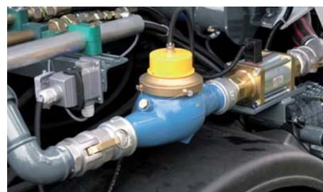
Водовод, дозатор воды
