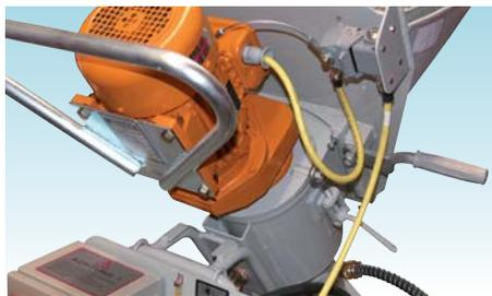
Projet Mix D2, смеситель с электромотором
