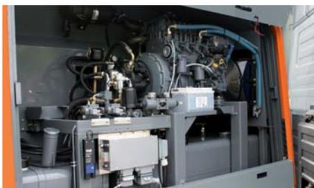
Powerpack с 4-х цилиндровым дизельным мотором
