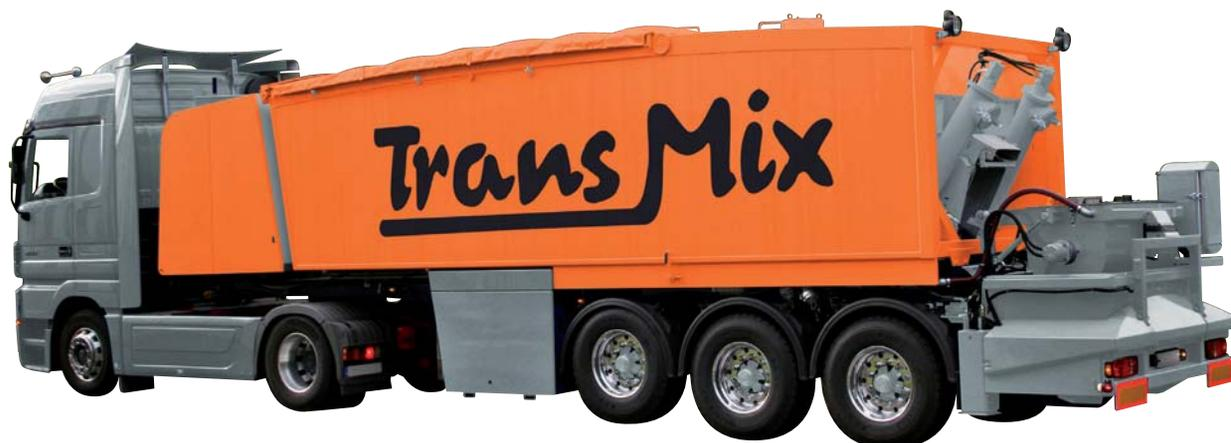
Trans Mix 3.200<sup>FE</sup> представляет собой 2- камерное сило в комбинации с мощным шнековым насосом. Установка является полностью автоматической. Всё необходимое для производства качественных стяжек, находится на борту установки, на строительной площадке остаётся только подключить воду.
