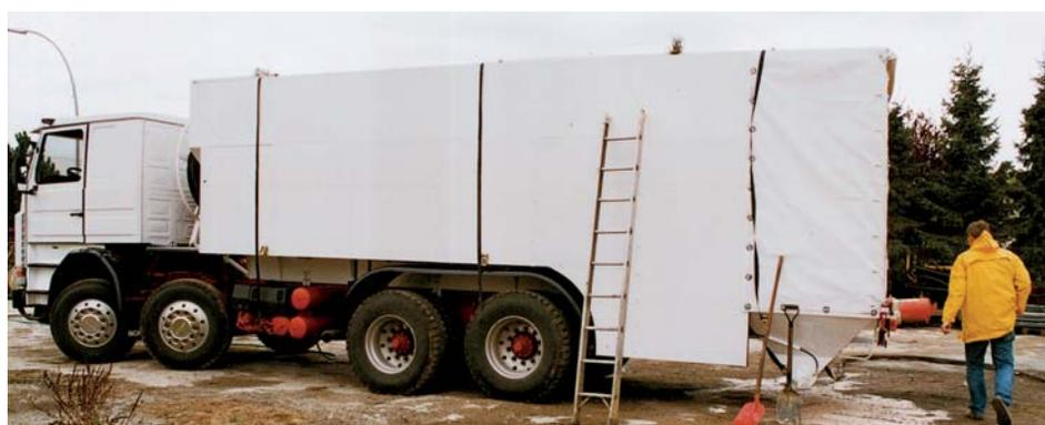
Установка для смешивания и подачи растворов для «жидких полов» сконструирована на 4-х осевом тягаче. Большой бункер для связующего, вмещает материал, для полного рабочего дня. Бункер для заполнителя заполняется лишь небольшой порцией, необходимой для начала работы, в дальнейшем бункер догружается специальным погрузчиком.
