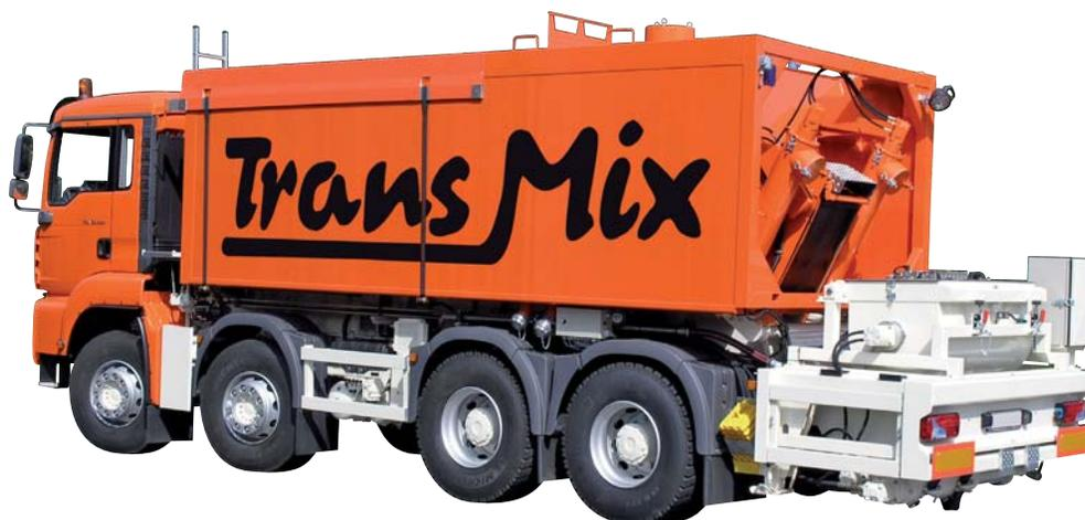
Trans Mix 3.200<sup>FL-8x4</sup> представляет собой 2- камерное силор в комбинации с мощным шнековым насосом. Установка является полностью автоматической, работает на основе весовых показателей. Всё необходимое для производства качественных стяжек, находится на борту установки, на стройплощадке остаётся только подключить воду.
