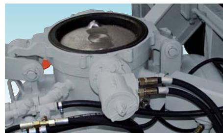
Фланец с гидравлическим приводом, на горловине смесителя
